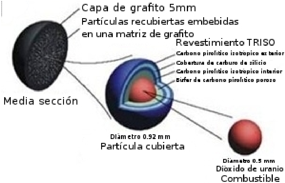
Figura 2.1: Partículas cubiertas de los elementos de combustible “pebbles” utilizados en reactores modulares de lecho de esferas PBMR.
