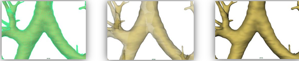
Figura 5.1.4.2 Prueba de existencia y eliminación de dobles caras 33 . Izquierda comprobación de existencia de dobles caras por selección. Centro comprobación de existencia de dobles caras por medio de transparencia ( X-Ray ). Derecha objeto sin dobles caras
