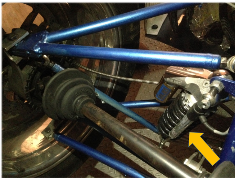
Figura 3.6: Montaje físico del potenciometro lineal en la suspensión trasera.
