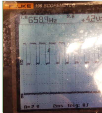
Figura 3.11: Captura de los pulsos producidos por el sensor inductivo.
