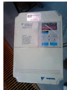
Figura 3.2 - Variador de Velocidad del túnel de viento
