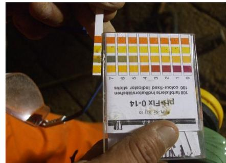
Foto 55: Resultado de la 2da prueba ph6
