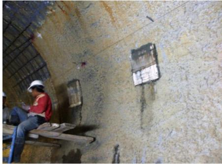
Foto 70: Pruebas de adherencia del concreto
