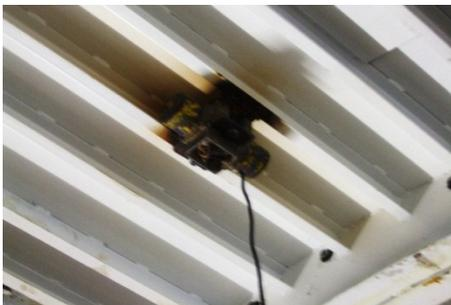
Foto 120: Vibrador Neumático de Pared
