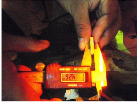
Foto 172: Pruebas de calidad a recubrimiento SYLPYL contra los gases
