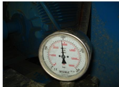
Foto 62: Manómetro de máquina de hidroescarificado
