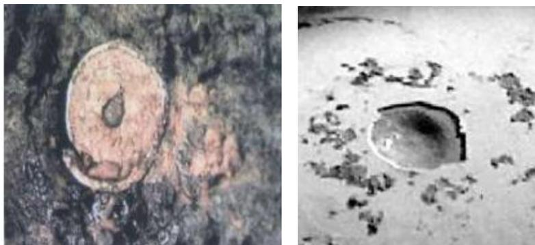
Fig. 12 Corrosión por AC en tuberías.
