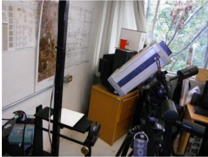
Figura 3.3 Montaje del instrumento y de la placa reflectora
