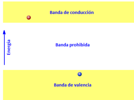
Figura 2.4 Modelo de la Teoría de Bandas en un elemento [19]
