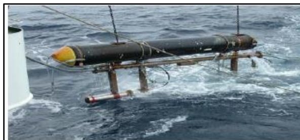
Figura 4.16_Figura que muestra un cañón de aire (Tomado de ION-GX- TECHNOLOGY, 2009).
