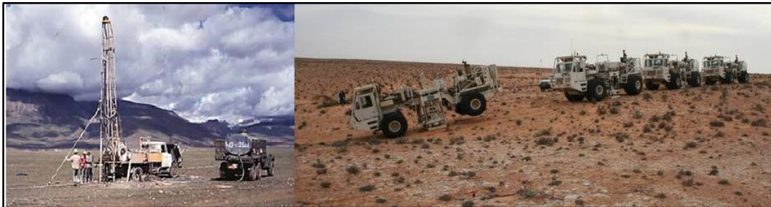
Figura 4.15_Fotos que muestran la perforación de un pozo para colocar dinamita y un camión Vibroseis (Tomado de http://www.mttmlr.com/sismologia_files/ , 2010).
