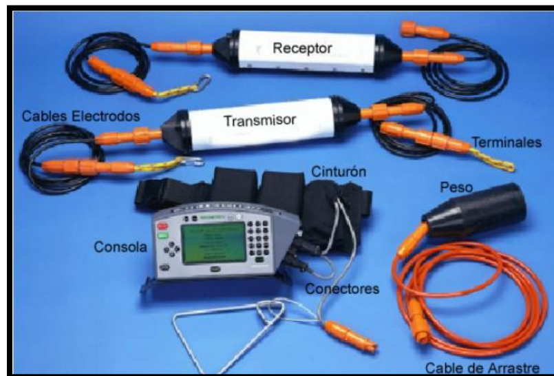
Figura (27).- Componentes del OhmMapper
