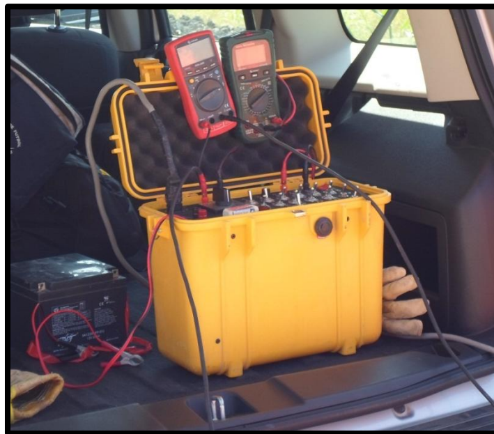
Figura 3.1. Transmisor de corriente eléctrica de 2 Kw de potencia y multímetro digital para medir el potencial.
