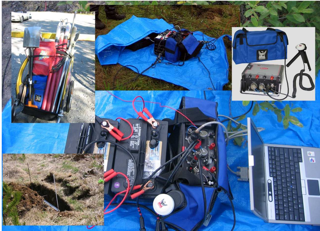
Figura 4.3 – Despliegue del Sistema V5 2000 en una adquisición de campo.
