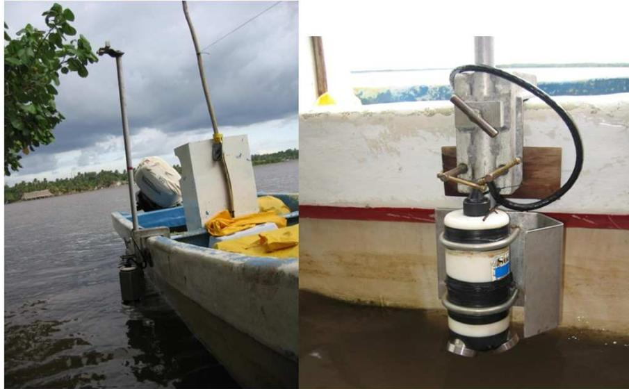
Figura 3.10 Perfilador de corrientes (ADP) instalado en la embarcación utilizada para recorrer los 4 transectos señalados.
