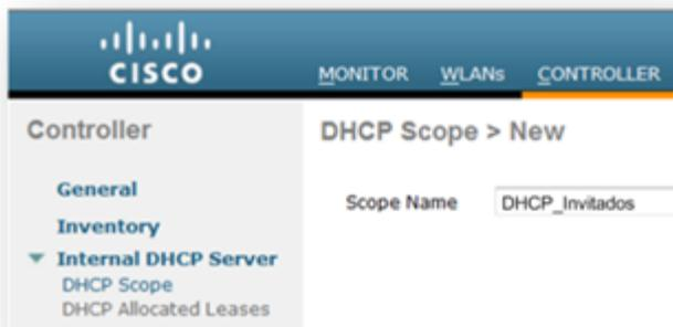
Figura 5.26 Creación de DHCP en la red WLAN Invitados
