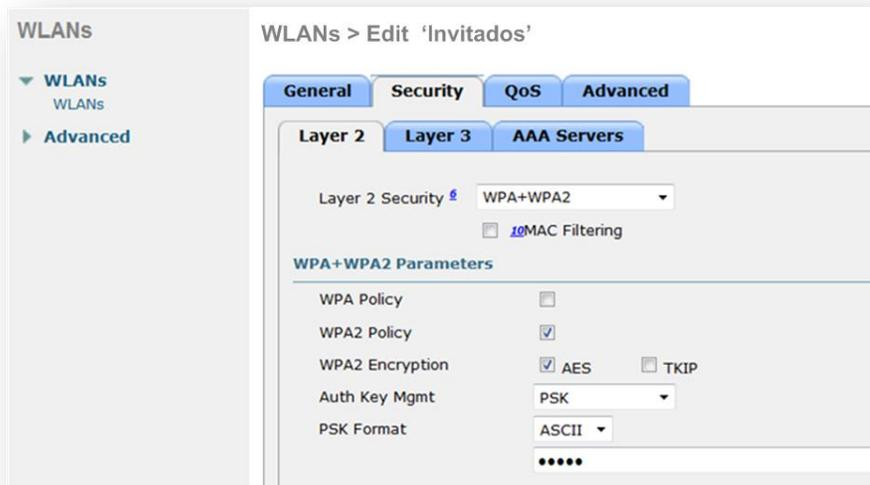
Figura 5.22 Configuración de seguridad en Capa 2
