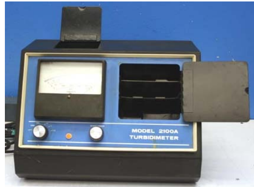
Figura 4.12 Turbidímetro nefelométrico HACH 2100 A utilizado en el laboratorio de TAR, FI UNAM.
