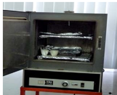
Figura 4.11 El secado de los crisoles Gooch para mantener a peso constante y para determinación de SST. Fuente: Laboratorio de Tratamiento de Aguas Residuales, FI UNAM.
