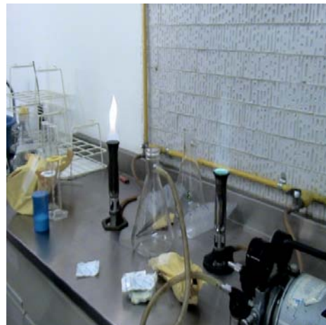
Figura 4.16 (arriba) Zona de trabajo, con los dos mecheros bunsen y el matraz de vacío para ayudar al filtrado de las muestras. Fuente: Laboratorio de Ingeniería Ambiental, FI UNAM.
