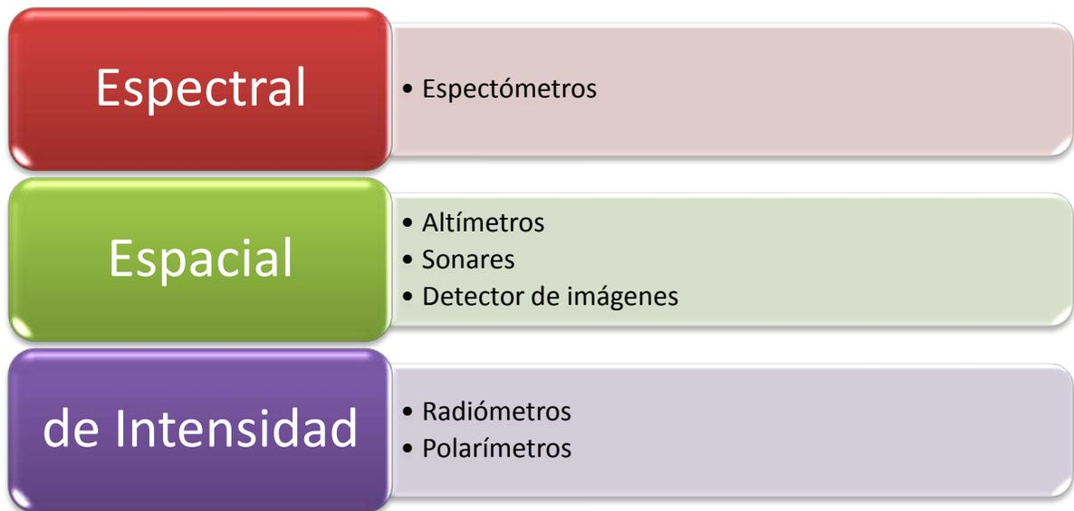
Figura 1.33 Parámetros determinados por las diferentes gamas de sensores. Fuente: Autor.
