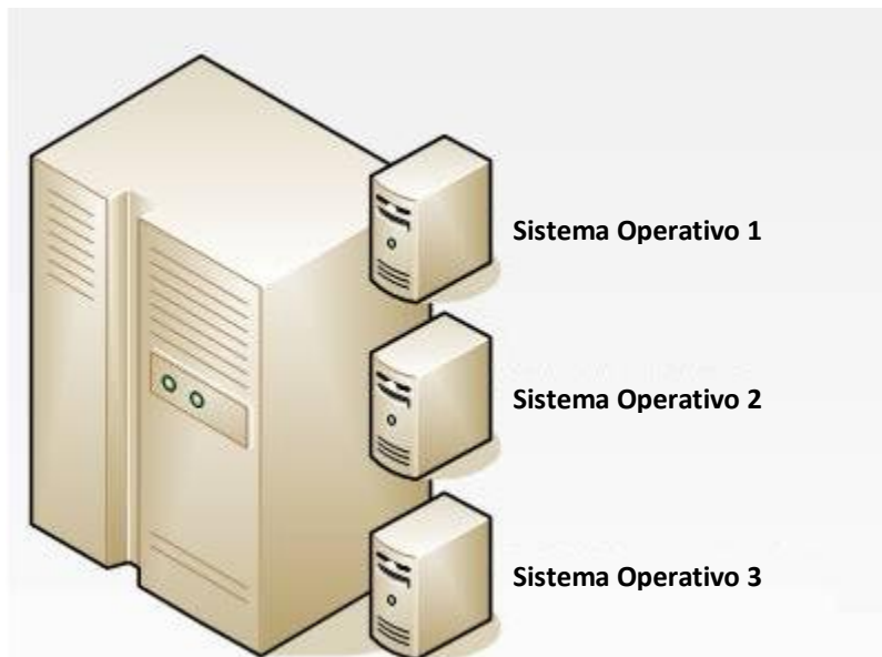
Figura 1.7. El VMM permite la utilización de diferentes sistemas operativos sobre las máquinas virtuales que él mismo soporta dentro de un servidor físico anfitrión.
