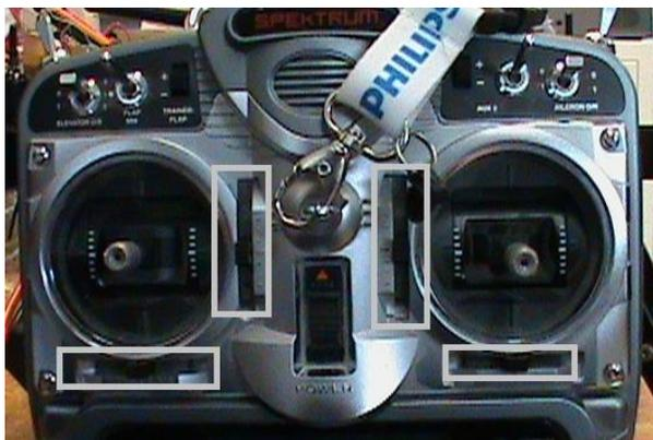
Figura 86. Trim, Ajustes en la salida del control.
