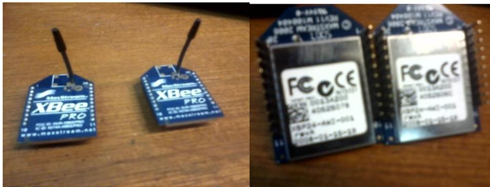
Figura 43. Módulos Xbee Pro XBP24
