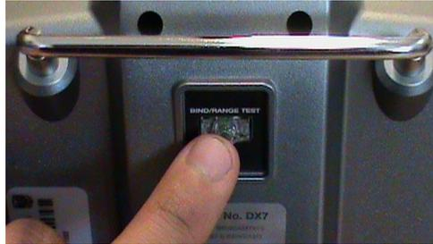
Figura 76. Botón BIND/RANGE TEST ubicado en el Control Spektrum Dx7
