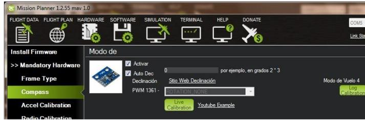
Figura 81. Captura de pantalla de la Activación del magnetómetro en el Mission Planner
