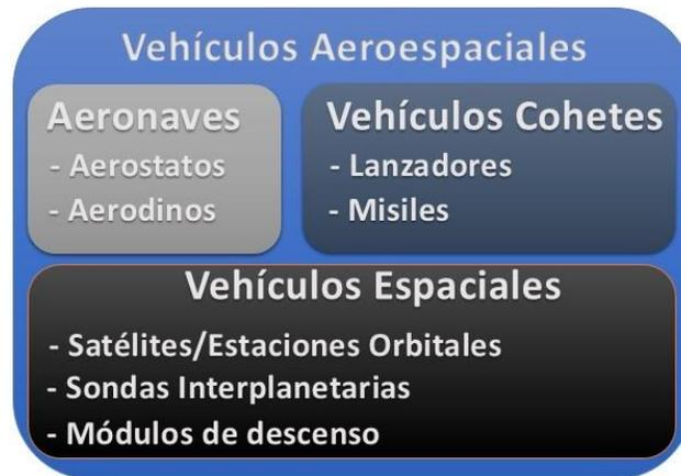
Figura 1. Clasificación de los Vehículos Aeroespaciales
