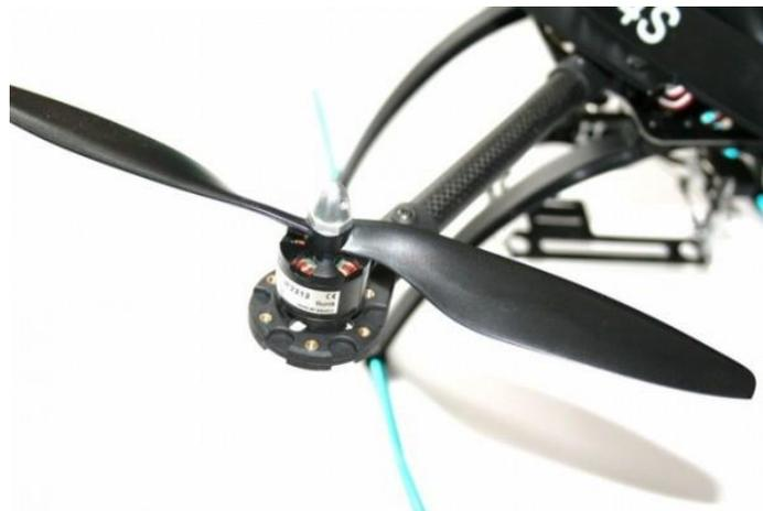
Figura 13. Rotor para QuadRotor
