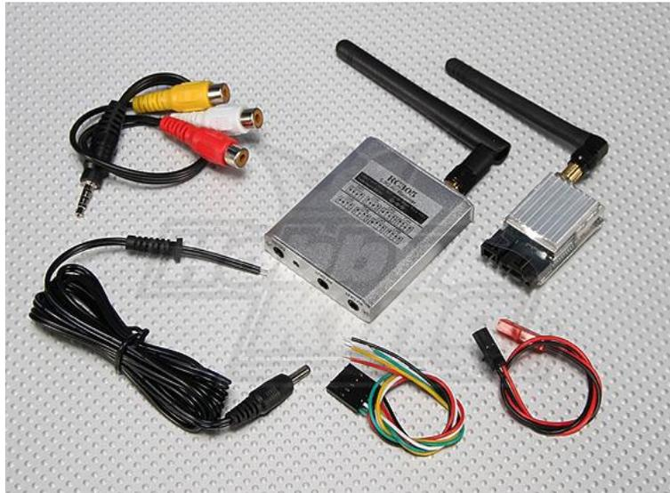
Figura 59 Sistema de Transmisión de video a 5.8 GHz Con 8 canales
