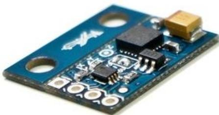
Figura 36. Magnetómetro con brújula HMC5883L de 3 ejes
