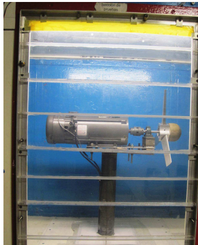
Figura B.3: Sección de prueba del túnel.
