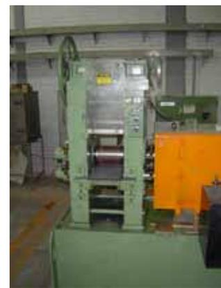
Figura 3.15 Rodillos del equipo de laminación (IIM – UNAM)
