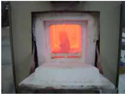
Figura 3.16 Pastilla dentro del horno a 800 °C
