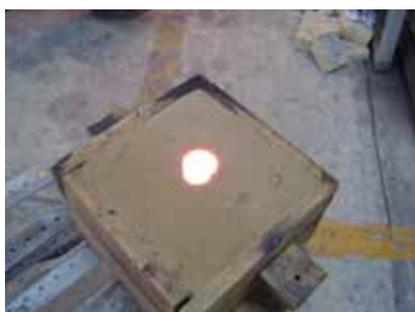
**Figura 3.11** Material fundido en la lingotera para obtención de pastilla para laminado
