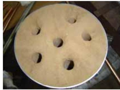
**Figura 3.4** Lingotera de arena para obtención de redondos
