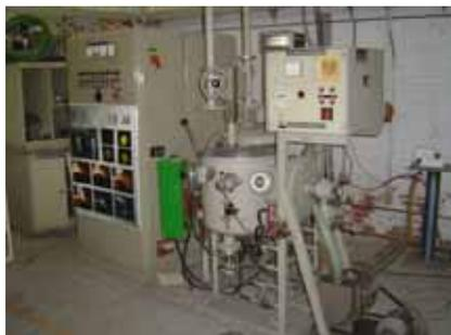
**Figura 3.5** Horno de inducción Leybold – Heraus del IIM - UNAM
