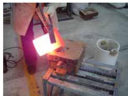
**Figura 3.10** Vaciado del material fundido en las lingoteras
