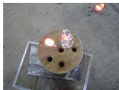
**Figura 3.12** Lingotera para obtención de barras
