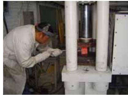
Figura 3.17 Colocación de la pastilla para el maclado
