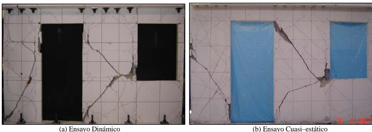
**Figura 5-74. Estado final del daño en el modelo MVN50m**
