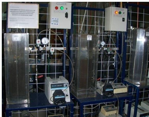
Figura 3.5. Sistemas experimentales: a) diagrama de los sistemas para la operación de los BRM; b) fotografía de los tres reactores
