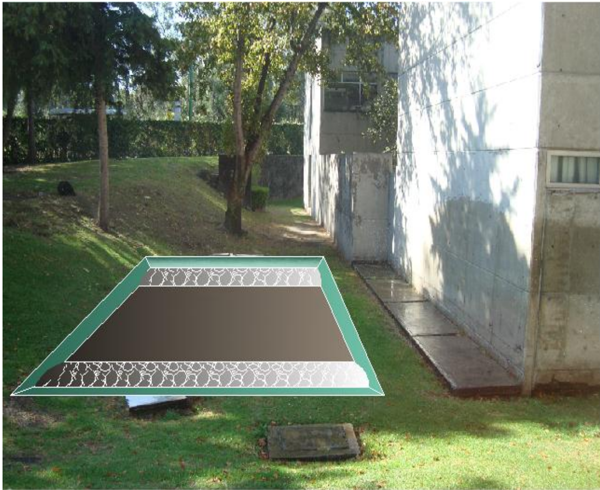
Figura 8.11. Colocado de arena- grava en la celda de tratamiento (aproximadamente 60 cm). Es necesaria la colocación de la grava más gruesa (5 a 10 cm de diámetro) al inicio y al final, abarcando una distancia de 0.5 a 1 m. Para el medio se utilizará el tamaño calculado (dependientes de la relación de vacíos y la conductividad hidráulica). Se debe tener cuidado en la colocación de las estructuras de entrada y descarga, que vayan por debajo del medio
