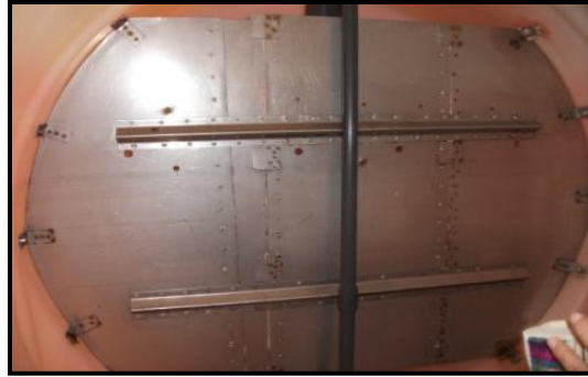
Fig.2.9 Primer mampara interna del separador.
