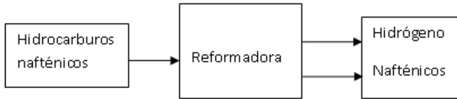
Figura 2.1 Proceso de producción de hidrógeno en una reformadora
