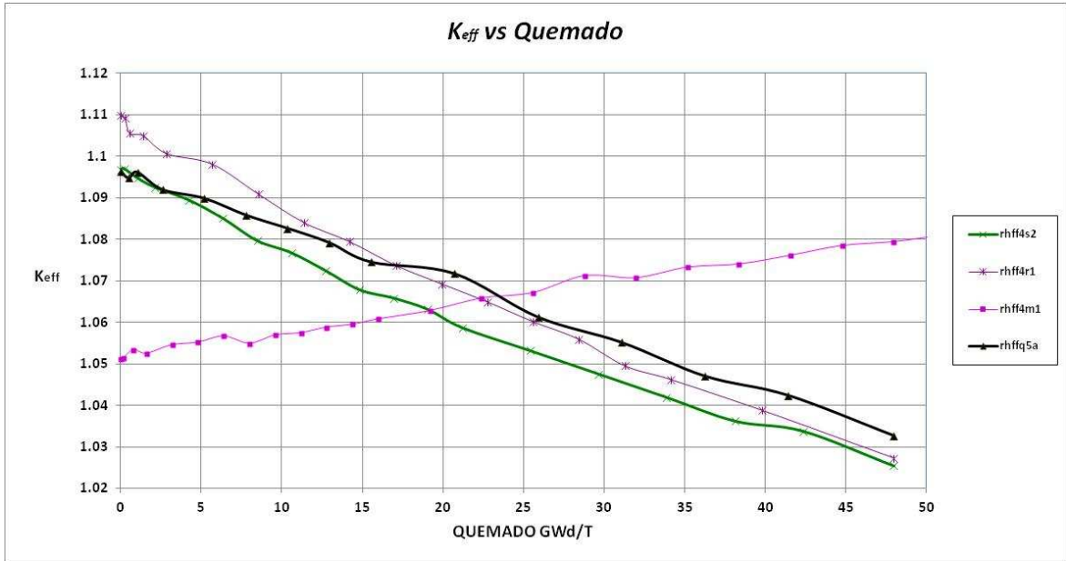
Figura 5.4. (a) K_{eff} vs quemado para el FFTS.
