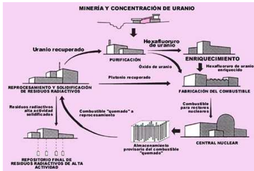
Figura 3.2. Ciclo del combustible nuclear con reprocesamiento y reciclado de combustible gastado.
