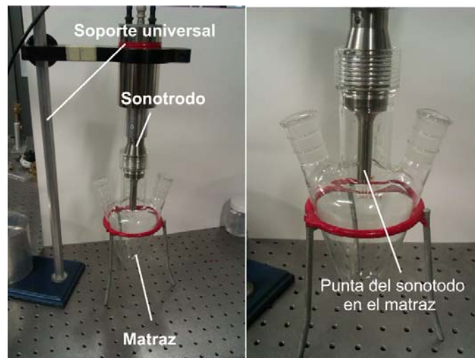
Figura 20. Vista del sonotrodo fijo en soporte universal y posición de la punta en el matraz
