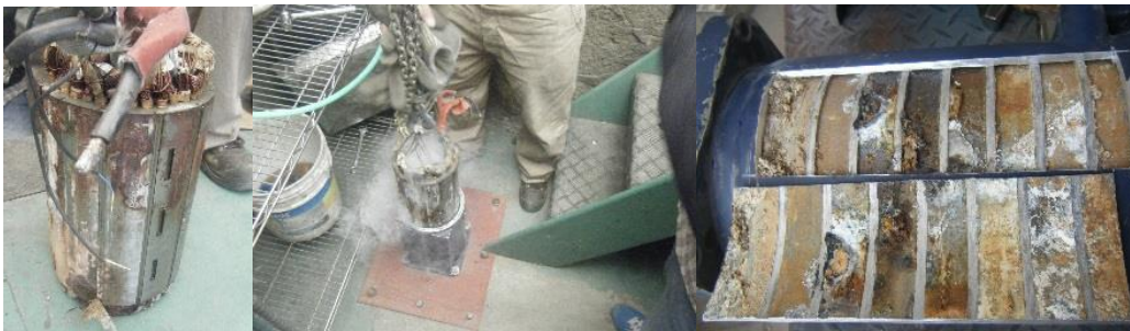
62. Proceso de desacople de estator.
