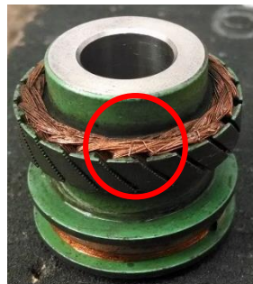
38. Devanado en núcleo dañado
