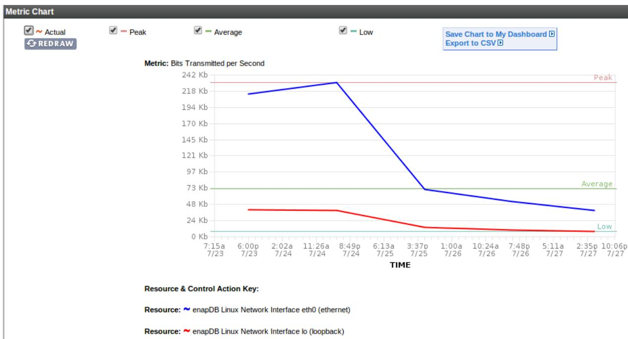
Figura 4.9. Bits transmitidos por segundo del servidor de BD
