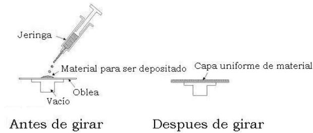
Figura 1.12: Proceso moldeado por giro [24].
