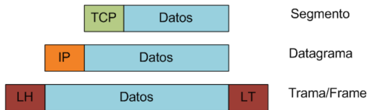
Figura 2.3: Perspectiva de encapsulamiento en cada Capa
