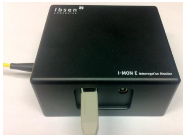
Figura 5.6. Analizador de Rejillas de Bragg (fotografía).
