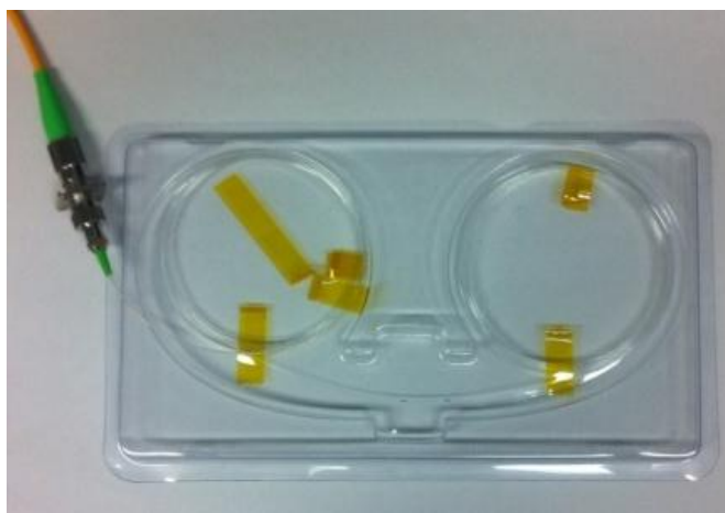
Figura 5.4. Rejilla de Bragg (fotografía).
