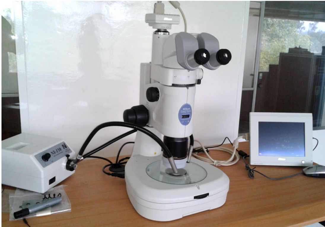
Figura 29: Microscopio óptico Nikon SMZ-1500 del Centro UNAMems. En la foto se observan la fuente de iluminación por fibra óptica y el monitor digital que muestra las imágenes de la cámara de video.
