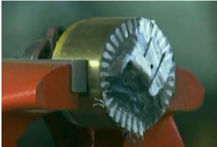
Figura 5.6. Rotor jaula de ardilla partido a la mitad, se logran observar las barras de aluminio coladas
