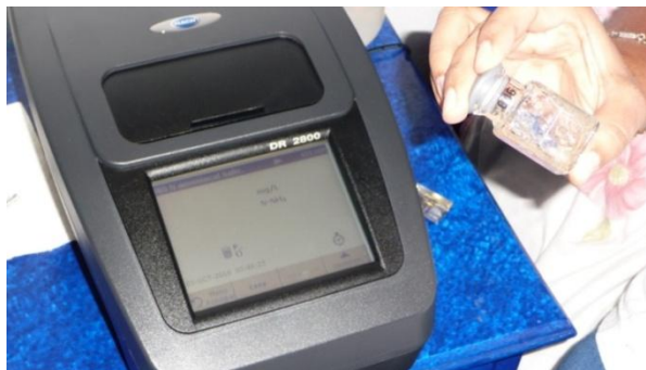
Figura 4. 8 Manejo y operación de espectrofotómetro HACH DR 2800
