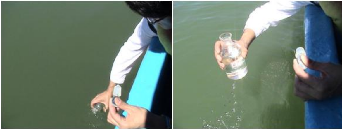
Figura 4. 3 Obtención de muestras con el frasco Winkler
