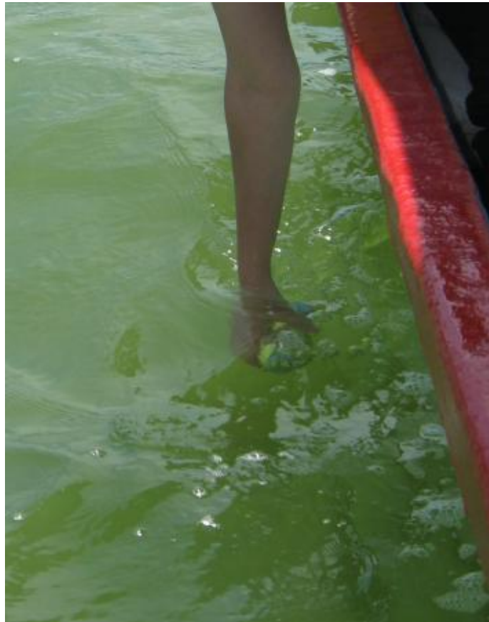
Figura 4. 2 Recolección de muestras simples para análisis físico-químicos
