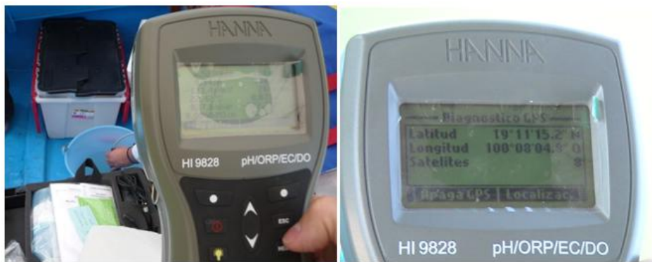
Figura 4. 4 Medidor multiparámetro con GPS HI 9828
