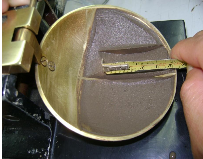
Fotografía 7 Medición de la unión entre la parte ranurada
