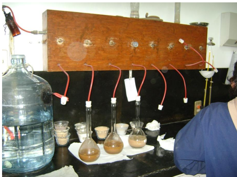
Fotografía 12 Sistema de vacío para poder extraer el aire atrapado
