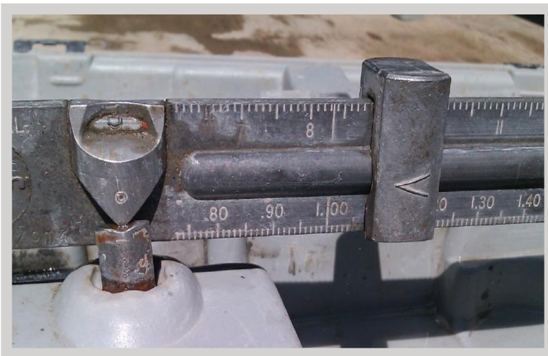
FIGURA NO. 5 Densidad del fluido de excavación
