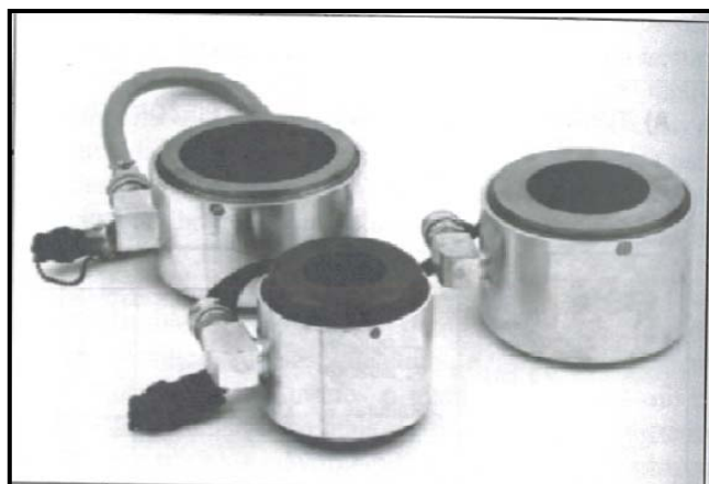
Figura 4.19 Célula de carga de cuerda vibrante Ref. [38]
