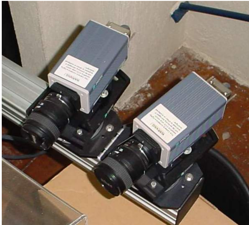
A2.11. Arreglos de cámaras CCD para PIV-3D
