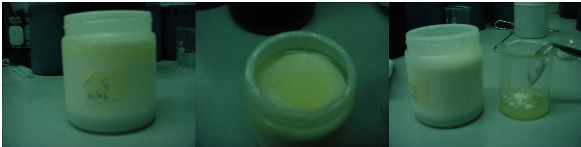
Figura A5.10. Emulsión E21-11 después del paso por la boquilla de atomización, original (izquierda y centro), depurada (derecha)
