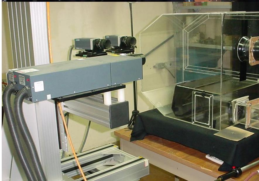
A2.10. Arreglos PIV-3D longitudinal (superior) y transversal (inferior)
