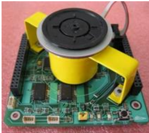
Figura 1.4. Subsistema de Estabilización de SATEDU.
