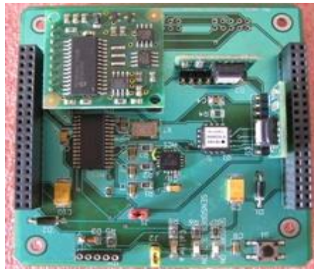
Figura 1.6. Subsistema de Sensores de Estabilización de SATEDU.
