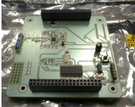
Figura 1.5. Subsistema de Comunicaciones de SATEDU.
