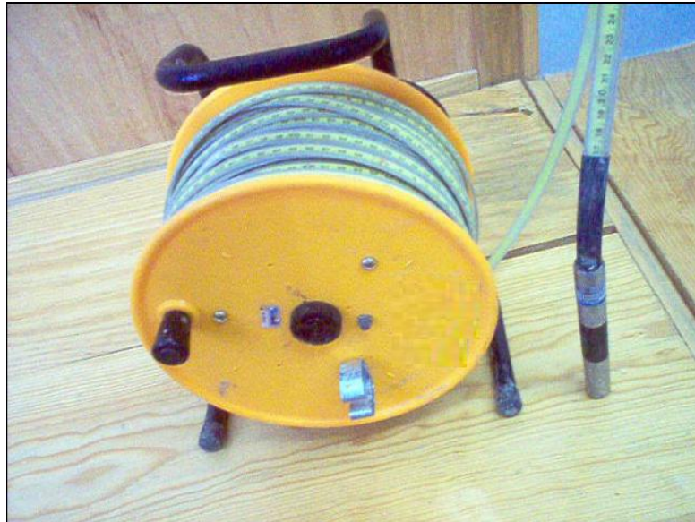
Figura 101. Vista de sonda magnética.
