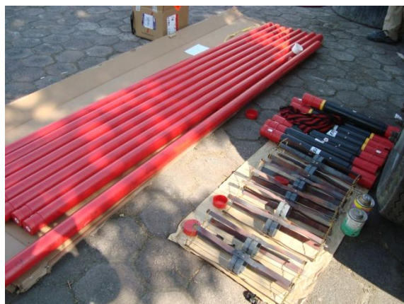
Figura 70. Elementos que conforman un Extensómetro Magnético.
