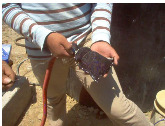
Figura 77. Filtro protector del Piezómetro de cuerda vibrante.
