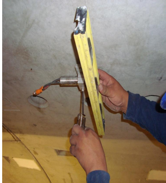
Figura 55. Nivelación de clinómetro uniaxial.
