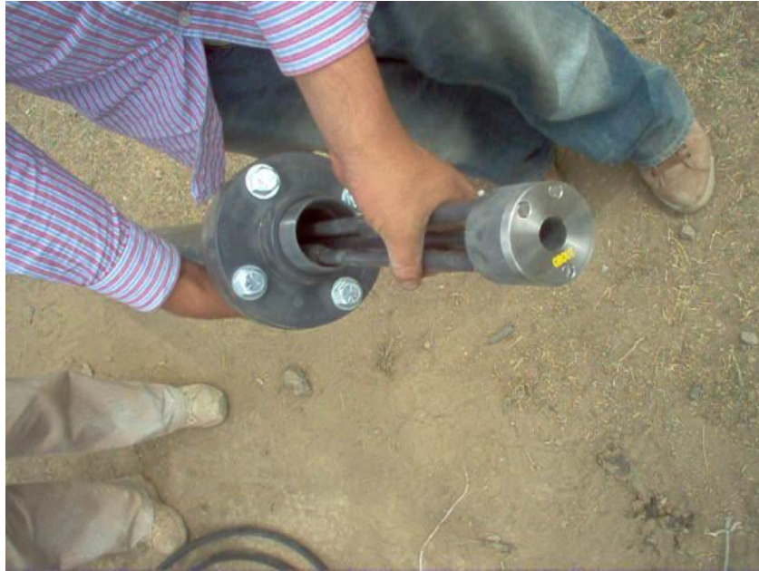
Figura 26. Ensamble de una cabeza de extensómetro de barras.
