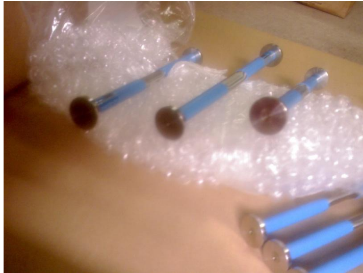
Figura 46. Deformímetros de concreto.
