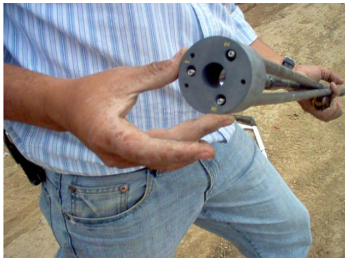
Figura 66. Barras de acero inoxidable identificadas en el cabezal .
