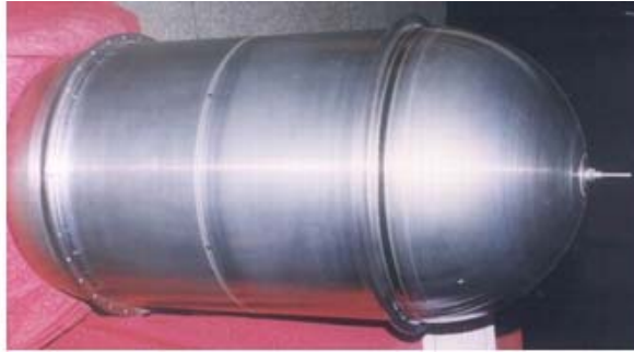
Fig. 2.5. Tanques de tensión superficial [177].
