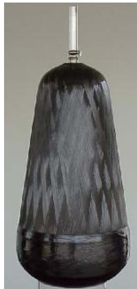
Fig. 2.4. Tanque cónico de diafragma reversible. Contiene un diafragma completamente reversible que permite evitar daño en el diafragma durante las pruebas de tierra [176].
