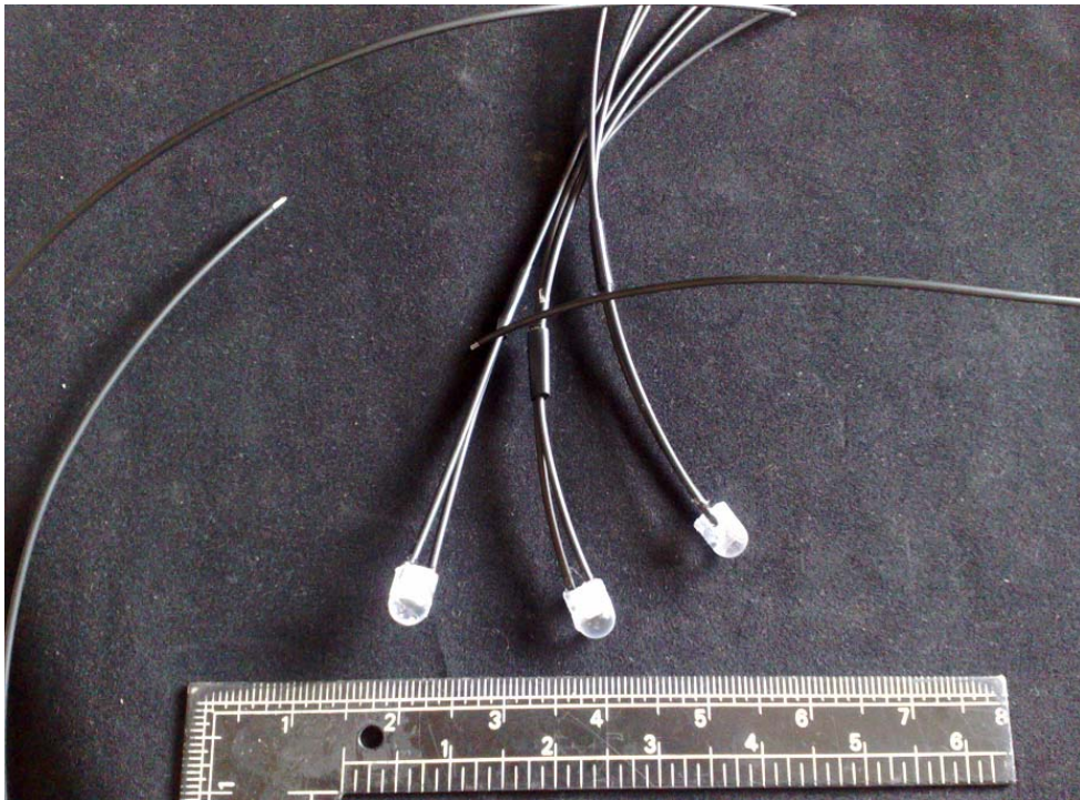
Fig. 6.35. Sensores refractométricos con elemento transductor semiesférico de 5 mm de radio de metacrilato y fibras ópticas del mismo material con apertura numérica NA de 0.5 y diámetro del núcleo de 0.98 mm.
