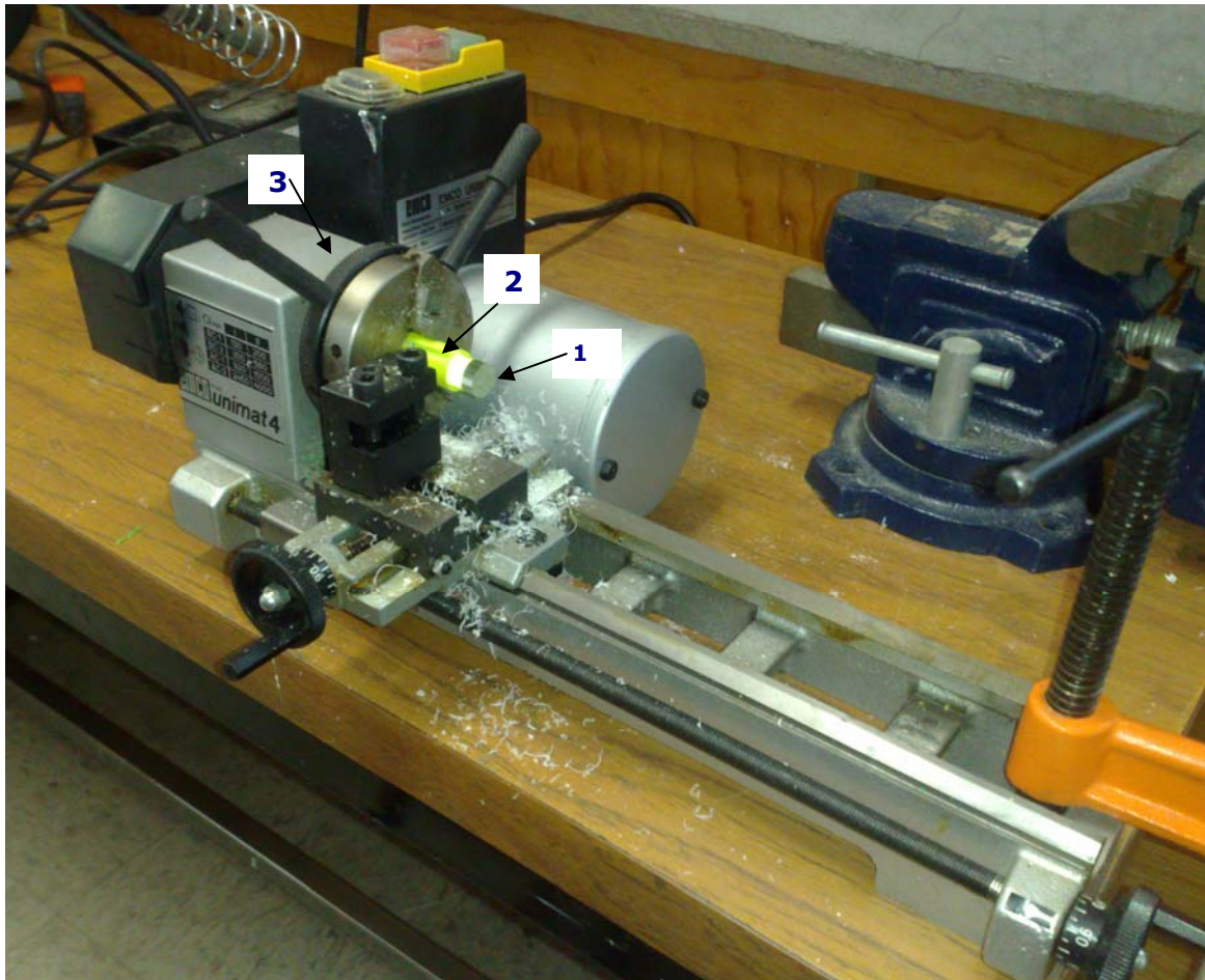
Fig. 6.2 Barras de PMMA de diferentes grosores utilizadas para la fabricación de elementos transductores.
