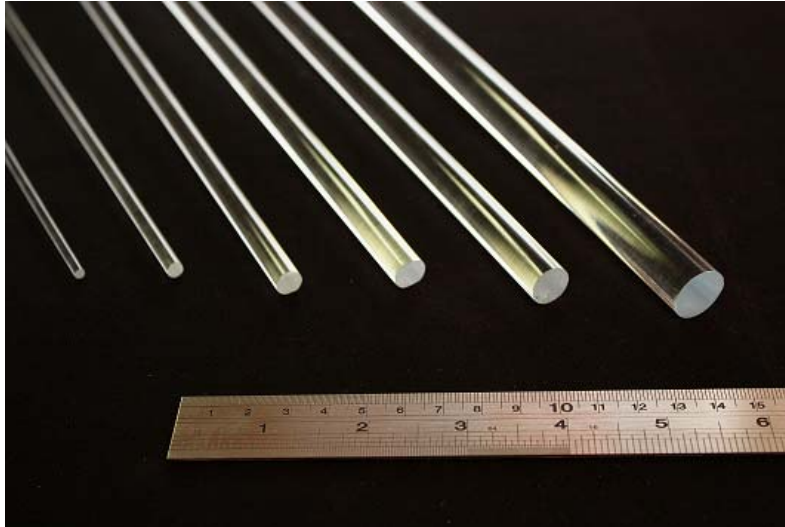
Fig. 6.2 Barras de PMMA de diferentes grosores utilizadas para la fabricación de elementos transductores.
