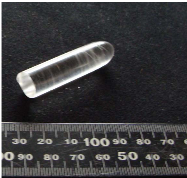
Fig. 6.4 Proceso de fabricación del elemento transductor a base de barra de PMMA. a), b) Devastado de barra; c) Proceso de limado para dar forma; d) Pieza bruta de PMMA con punta semiesférica semi pulida.
