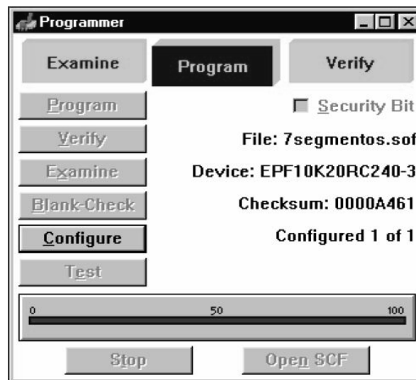
Figura 3.10. Proceso de grabación del diseño en el dispositivo seleccionado con el programador de MAX + plus II
