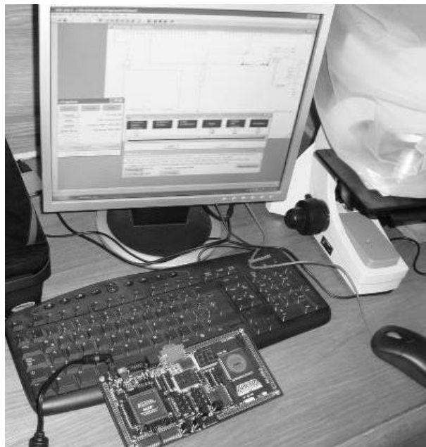
Figura 4.17. Programación del dispositivo en la tarjeta de desarrollo de Altera
