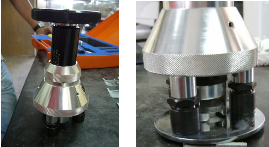
Fig. 4.25 Equipo para medición de adherencia marca Elcometer 106 según norma ASTM 4541
