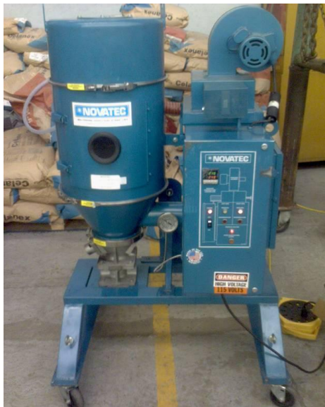
Figura 4.5 a) Equipo Novatec para el secado de pellets, b) Medidor de humedad Ohaus MB45
