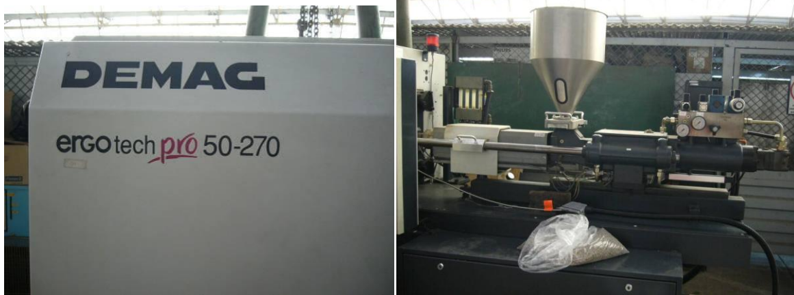
Figura 4.4 Inyectora DEMAG Ergotech pro 50-270.
