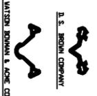
② La forma de la sección de acero mostrada es típica. Las variaciones que dependan del fabricante son permitidas. Como se indica en el dibujo, el sello debe estar en contacto con el acero.
