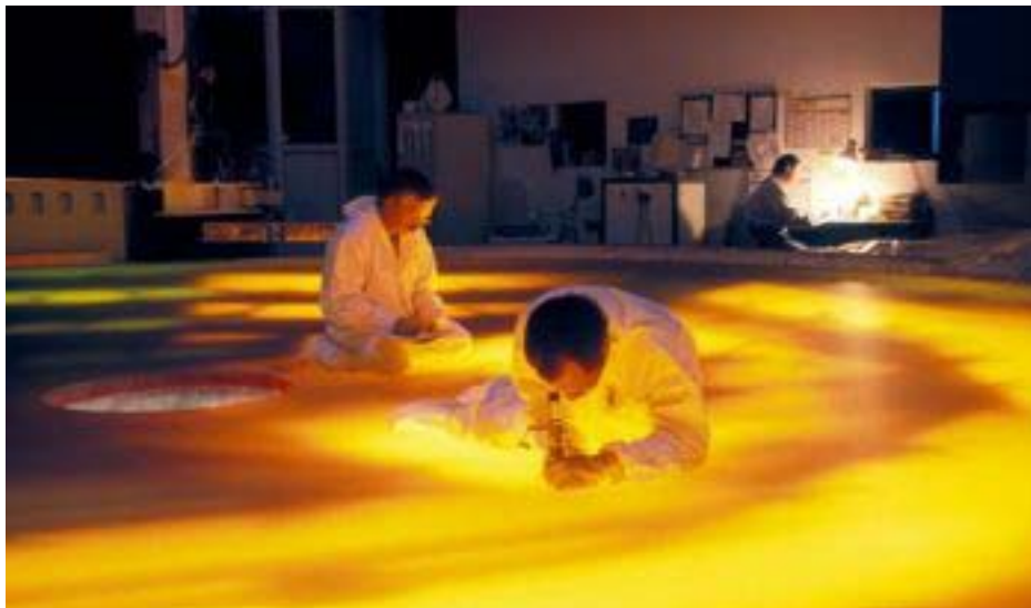
Figura I.3 Inspección de uno de los 4 espejos primarios del Very Large Telescope con diámetro de 8.2 metros (Foto tomada de sciencephoto.com).
