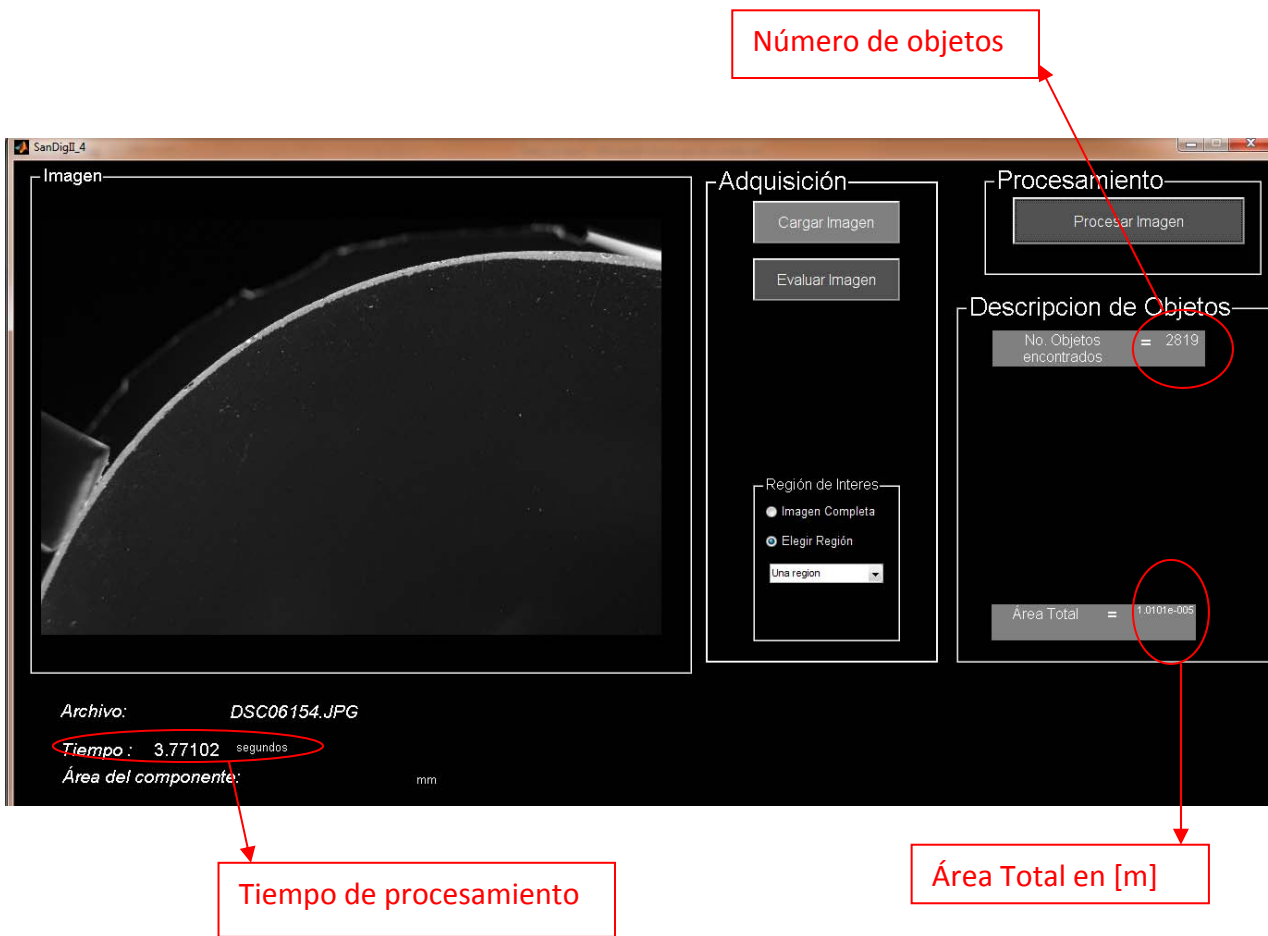
Figura V.35 No. De objetos, área equivalente y tiempo de procesamiento, mostrados en la interfaz.
