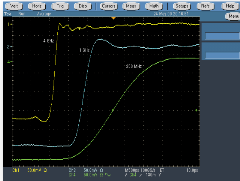
Figura A2.1. Un mayor ancho de banda por parte del osciloscopio permite reproducir con mejor precisión el comportamiento de una señal. Tal efecto se ilustra en esta figura en donde para la misma señal de entrada se tienen representaciones diferentes para los anchos de banda de 250MHz, 1GHz y 4GHz.
