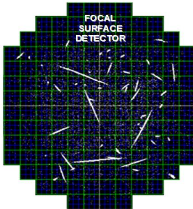
Figura 1.2.3.3. [11-a]. Imágenes de trazas simuladas sobre la superficie focal, de eventos EAS producidos por partículas de 10^{20} eV. Las diferencias en longitud proyectada se deben fundamentalmente a diferentes ángulos cenitales de incidencia del rayo cósmico primario.
