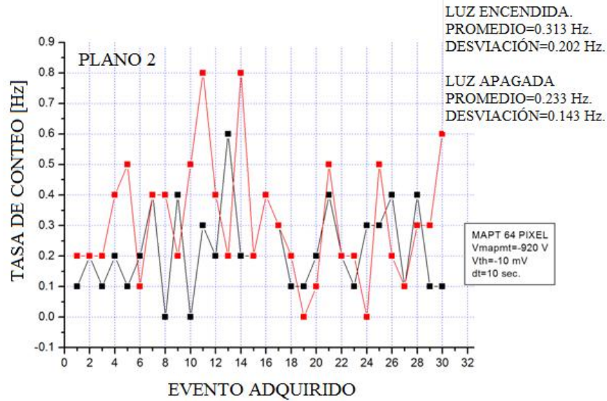
Figura 2.2.4 Nivel de oscuridad del plano 2 de la Cámara promediado por tres pixeles del MAPMT. La curva en rojo representa el levantamiento con la luz externa a la Cámara Oscura en estado de encendido, mientras que la curva en negro representa el estado de apagado.
