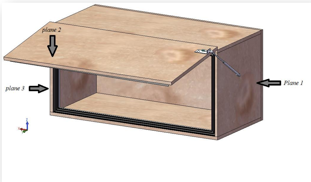
Figura 2.2.1. Modelo en CAD prototipo de la Cámara Oscura para desarrollo del Track-Flat.
