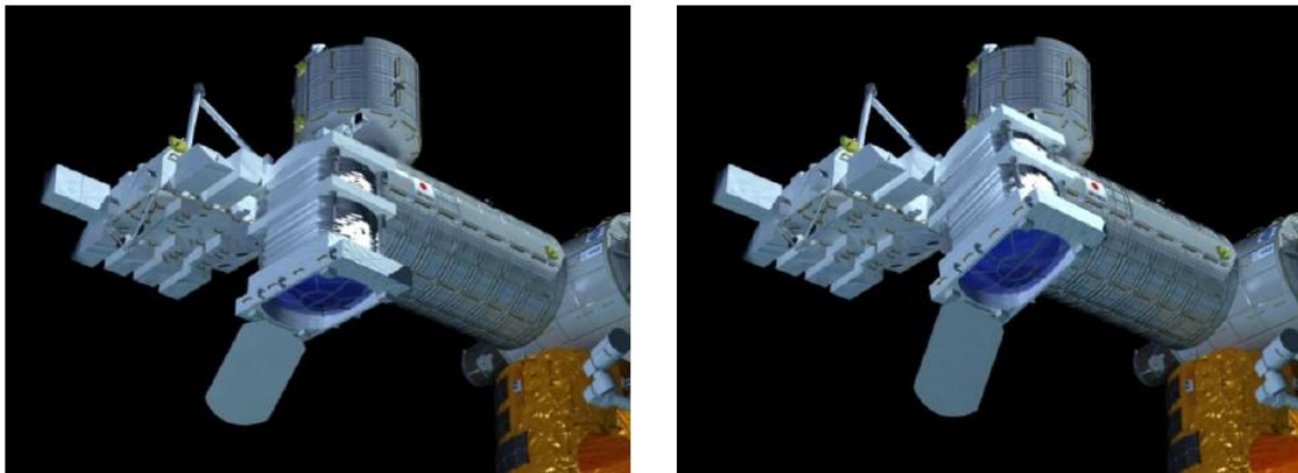
Figura 1.1.2. Ilustración del telescopio JEM-EUSO anclado al Modulo de Experimentación Japonés (JEM) de la Estación Espacial Internacional (ISS), en modo de observación nadir (izquierda) y modo de observación de inclinación (derecha).
