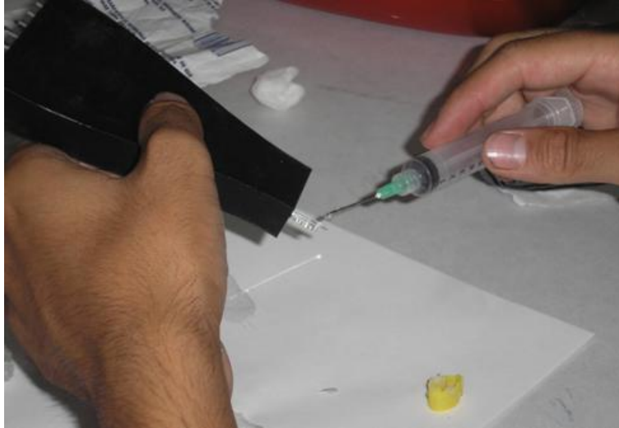
Figura 3.3.4. Se muestra el pegado de la fibra dentro de los canales designados. El epóxico fue aplicado tanto del lado de emisión, como del lado de acoplamiento.
