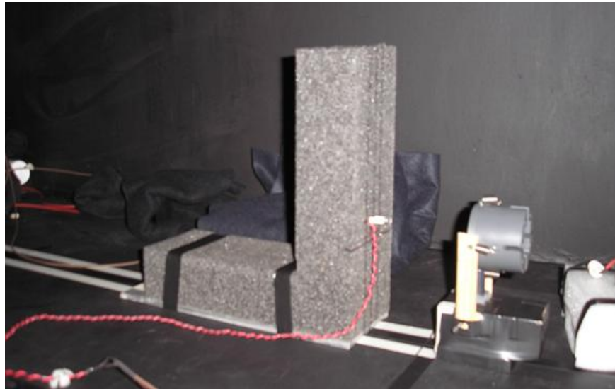
Figura 2.3.1.1. Emisión directa del LED uv hacia el sensor MAPMT para determinar el estado SPE.
