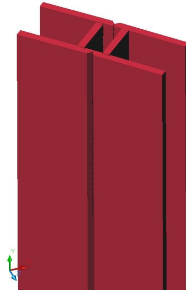
Placas de conexión, parte superior
