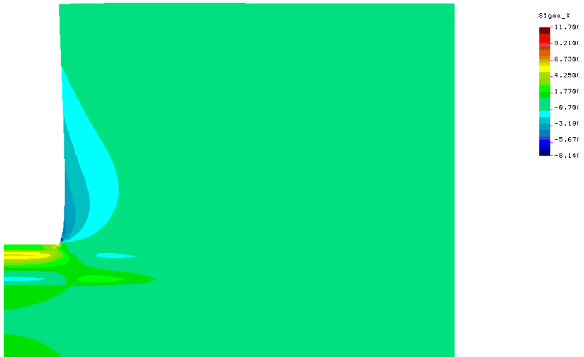
Figura 85. Esfuerzos horizontales. Se marca la influencia de la CD. Unidades en ton y m. Los valores negativos representan la compresión y positivos la tensión.
