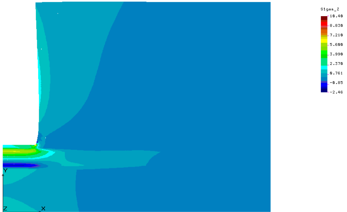
Figura 87. Esfuerzos horizontales perpendiculares al plano de dibujo. Unidades en ton y m. Los valores negativos representan la compresión y positivos la tensión.
