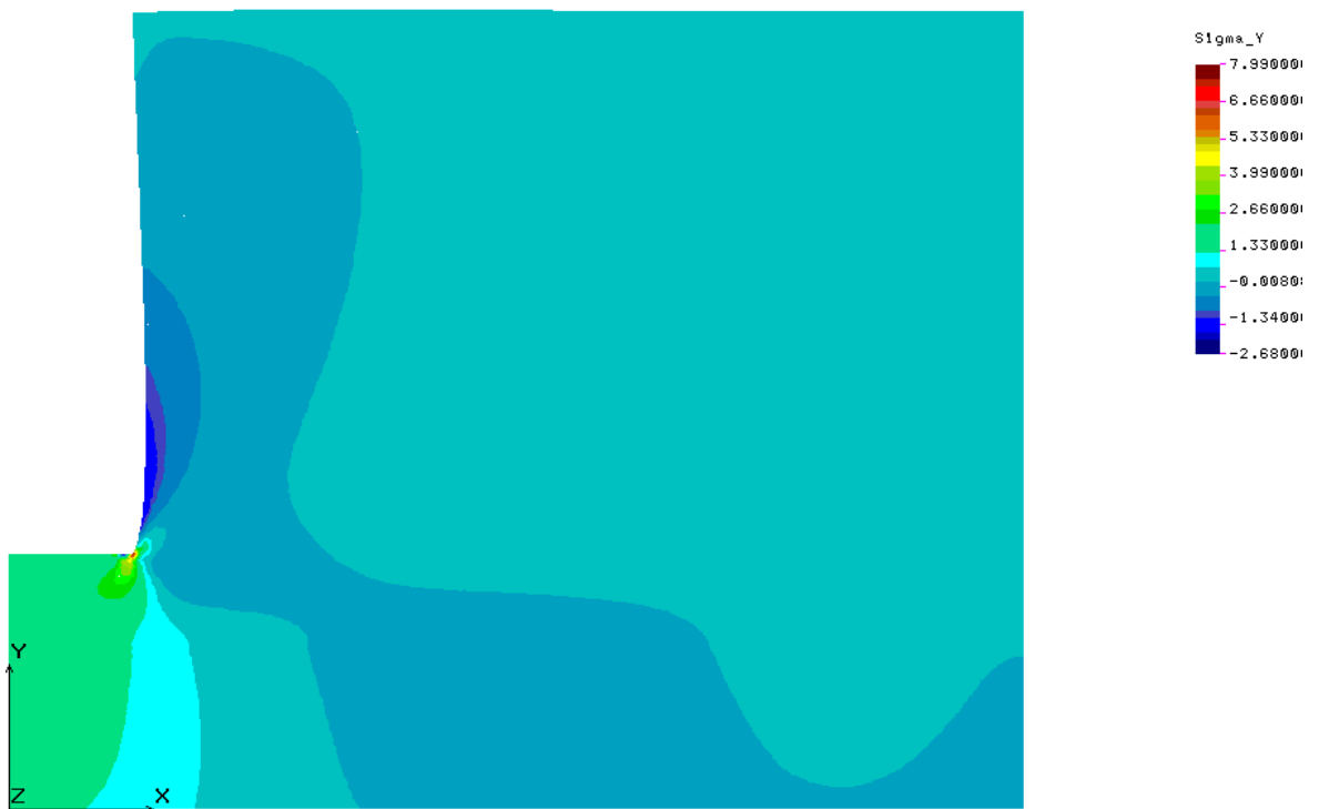
Figura 86. Esfuerzos verticales normales. Unidades en ton y m. Los valores negativos representan la compresión y positivos la tensión.
