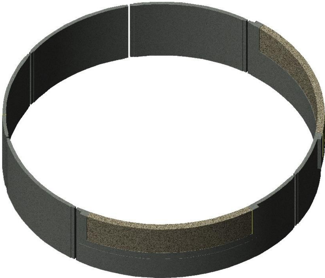
Figura 41. Segundo anillo, dovelas de concreto reforzado con zonas de mortero para facilitar el paso de la zona inferior de escudo.
