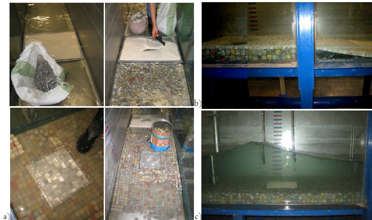
Figura 2.7 En a) se aprecia la construcción de la estructura que permitiría lograr alcanzar el nivel del recipiente que contendría la muestra, así como igualar en lo posible las rugosidades de la misma y su alrededor. En b) se presenta la estructura mencionada terminada, y en c) la ubicación de: cañón del PIV, los dos vectrinos y un sensor de nivel bajo (de izq. a der.) durante la realización de una prueba.
