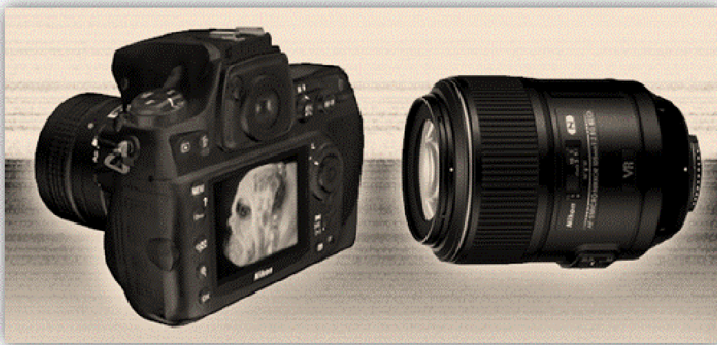
Figura 2.4 Cámara Nikon y objetivo AF-S VR Micro Nikkor 105 mm f/2.8G IF-ED) empleados, con dispositivo disparador y reductor de vibración (VR), auto enfoque (AF) y autoenfoque interno (IF) para distancias de enfoque más cortas, y cristales ED para la corrección de color y brillo.
