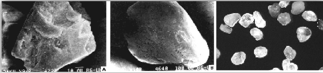
Figura 1.12 A la izquierda y al centro se muestran dos imágenes capturadas por medio de un SEM (tomadas de Goldbery, 1989), donde claramente se observa la textura de los granos; a la derecha, una imagen capturada por medio de un LM (tomada de Cox, 2008) donde se observa una mayor facilidad para la conversión a binario y realizar el análisis por computadora.
