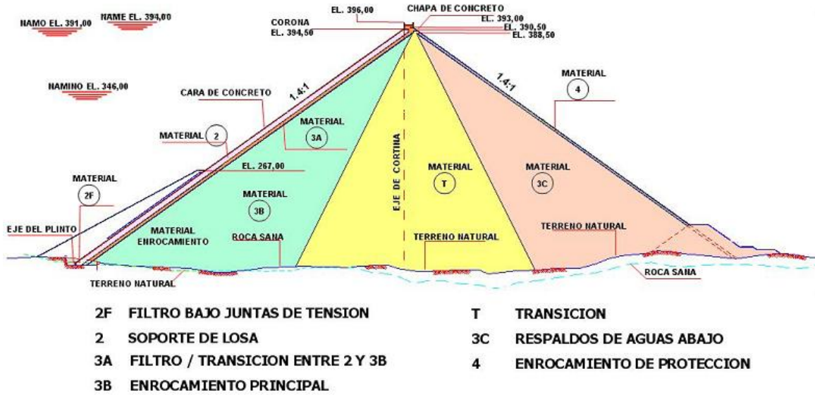
Figura II.11. Sección máxima de la cortina, indicando la zonificación de los materiales.
