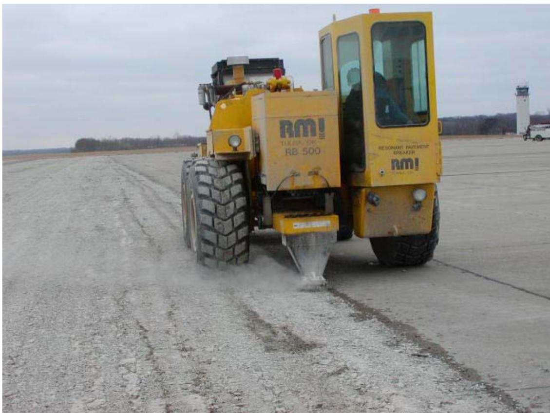
Figura 2.20 Máquina resonante rompedora de pavimento (RMI, Inc.).
